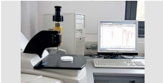
Die FTIR-Spektroskopie mit ATR-Technik analysiert zerstörungsfrei die qualitative Zusammensetzung organischer Stoffe.
